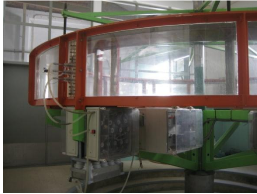
Figura 11 – Canal anular do LNEC
