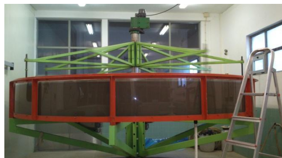
Figura 13 – Canal anular com suspensão do sedimento
